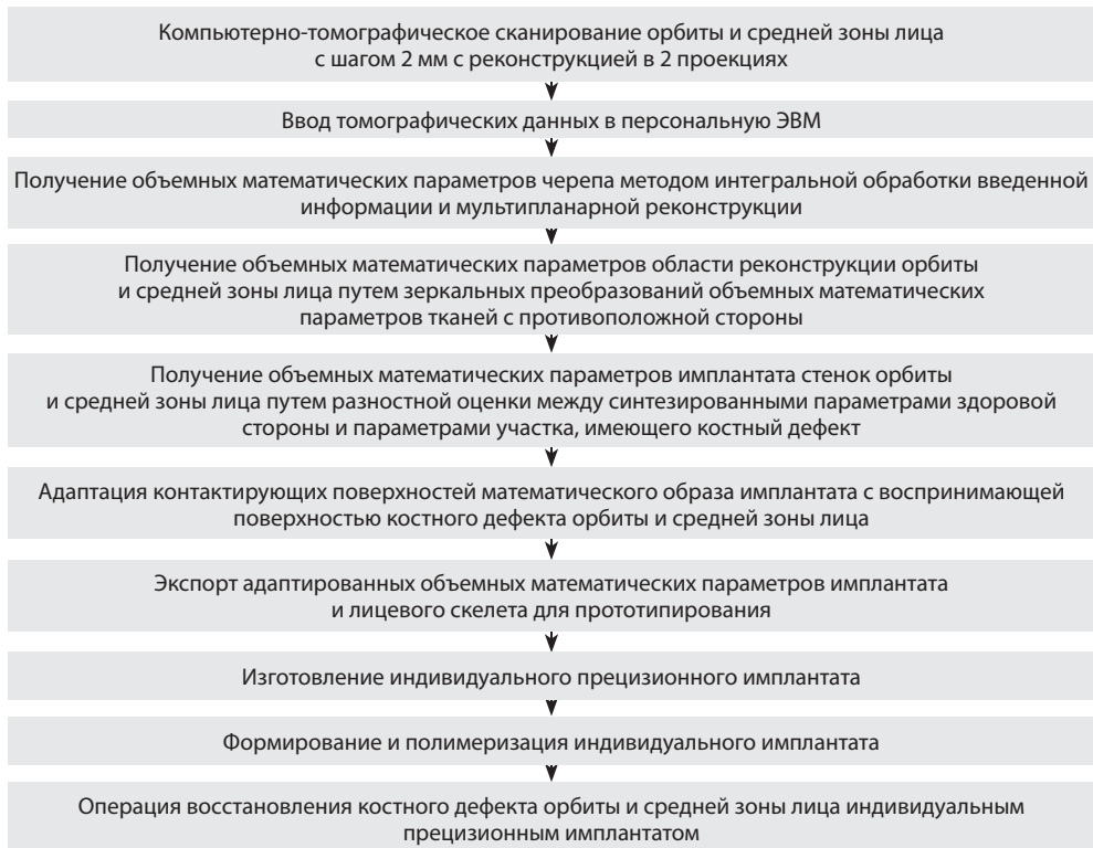
Рис. 3. Порядок действий при изготовлении индивидуализированного прецизионного имплантата для восполнения костного дефекта стенок орбиты и средней зоны лица Fig. 3. Procedure of actions during the manufacturing of the individualised precision implant for the bone defect replacement of the orbital walls and the middle zone of the face
