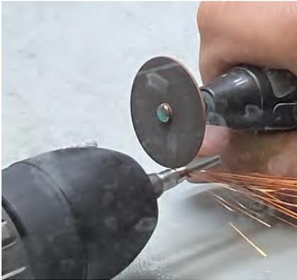
**Рис. 4. Процесс модификации цоколя фрезы**
