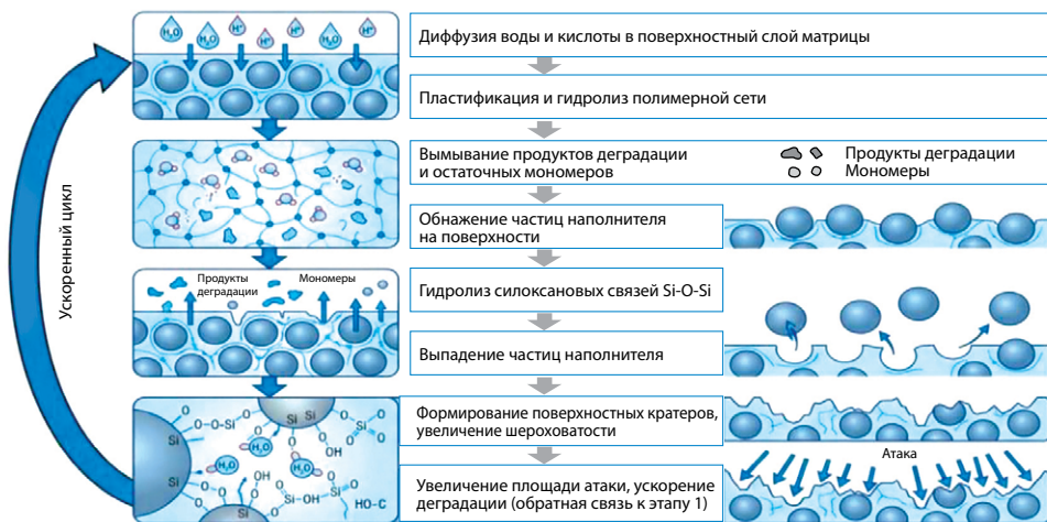
Рис. 2. Каскадный механизм эрозивной деградации композитных материалов Fig. 2. Cascade mechanism of erosive degradation of composite materials
